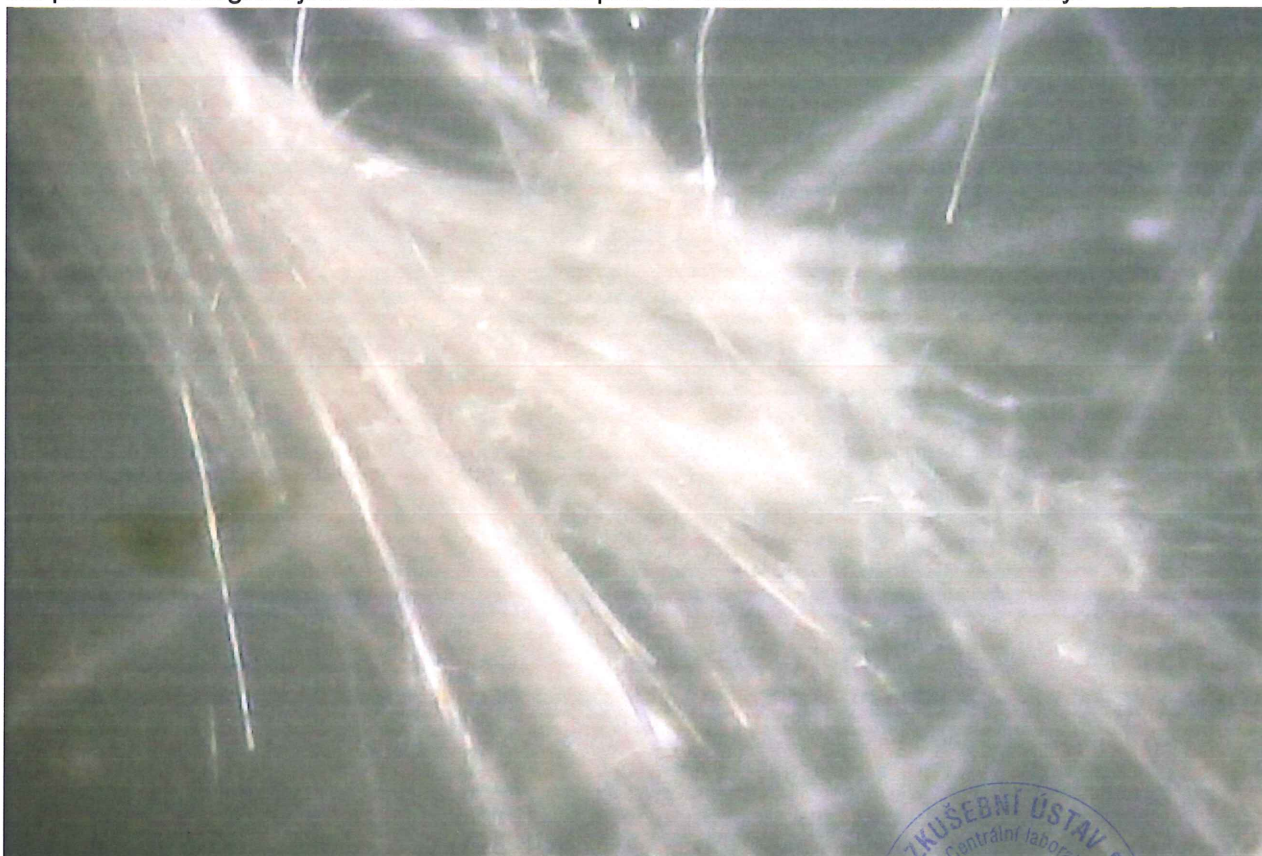
VZ 030160905 - Fotografie vláken izolovaných ze vzorku desky s omítkou
