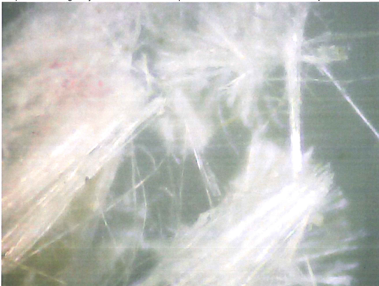
VZ 030160906 – Fotografie vláken izolovaných ze vzorku desky s omítkou
