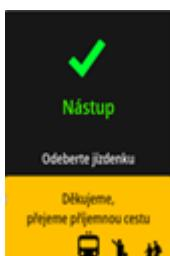
Úspěšné odbavení při nástupu do vozidla je cestujícímu potvrzeno zatržítkem zelené barvy doplněné akustickým signálem a řidiči vozidla se na palubním počítači zobrazí rovněž úspěšné odbavení.
