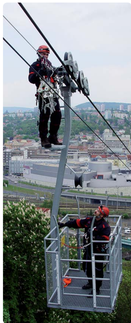
Strojníci Z. Zimmermann (dole) a K. Mařík při nácviku evakuace cestujících z uvízlé kabinky. Foto V. Blažek
